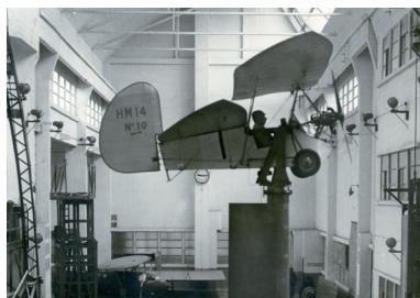
Installé dans la grande soufflerie de Chalais-Meudon, le Pou du Ciel, de par sa taille réduite, ressemble à une maquette, juillet 1936 (Collection musée de l'Air et de l'Espace – Le Bourget)
