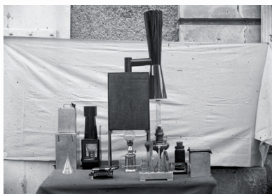
Système pour le vidage de lampes triodes inventé par Henri Mignet, vers 1921 (Collection FAR - Fonds Henri Mignet)
