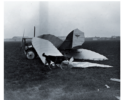
Sur l'aérodrome d'Orly, en 1929, le HM 9 «se bigorne» 2 suite à la rupture d'un hauban supportant l'aile. Cet accident ferme un temps l'accès des aérodromes publics à Henri Mignet (Collection FAR – Fonds Henri Mignet)
