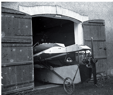
Grâce à son aile repliable et se dédoublant, l'HM 4 peut sortir sans difficulté du hangar aménagé par Henri Mignet dans la propriété familiale du Logis du Pinier à La Vallée (Charente-Maritime), 1923 (Collection FAR – Fonds Henri Mignet)
